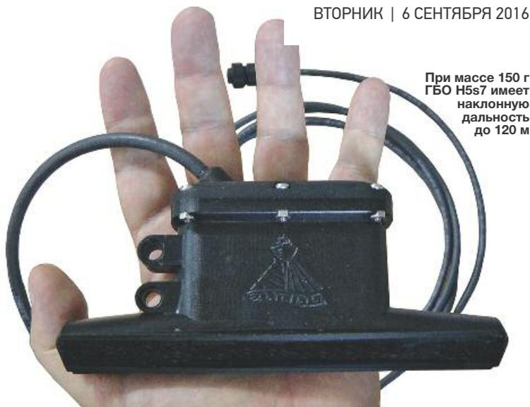
При массе 150 г ГБО Н5s7 имеет наклонную дальность до 120 м
