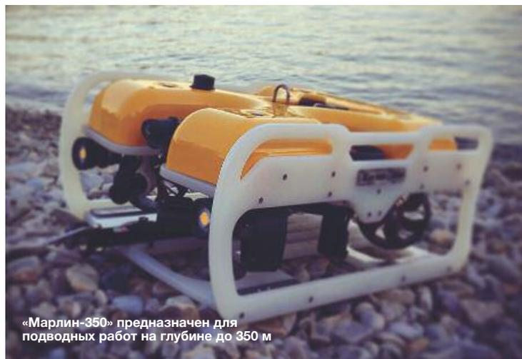
«Марлин-350» предназначен для подводных работ на глубине до 350 м
