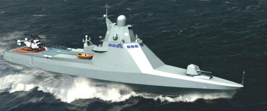
Первый в России, уникальный, многоцелевой корабль, строящийся по модульному принципу. Спроектирован по технологии «Стелс». Имеет неограниченную мореходность, что обеспечивает возможность свободного маневрирования и использования вооружения и технических средств при волнении моря до 9 баллов включительно, при движении на любых скоростях хода.
