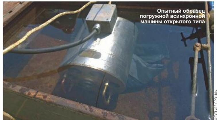
Опытный образец погружной асинхронной машины открытого типа
