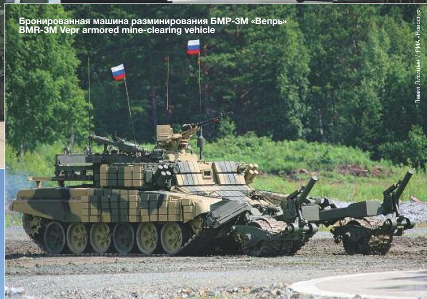
Бронированная машина разминирования БМР-3М «Вепрь»
