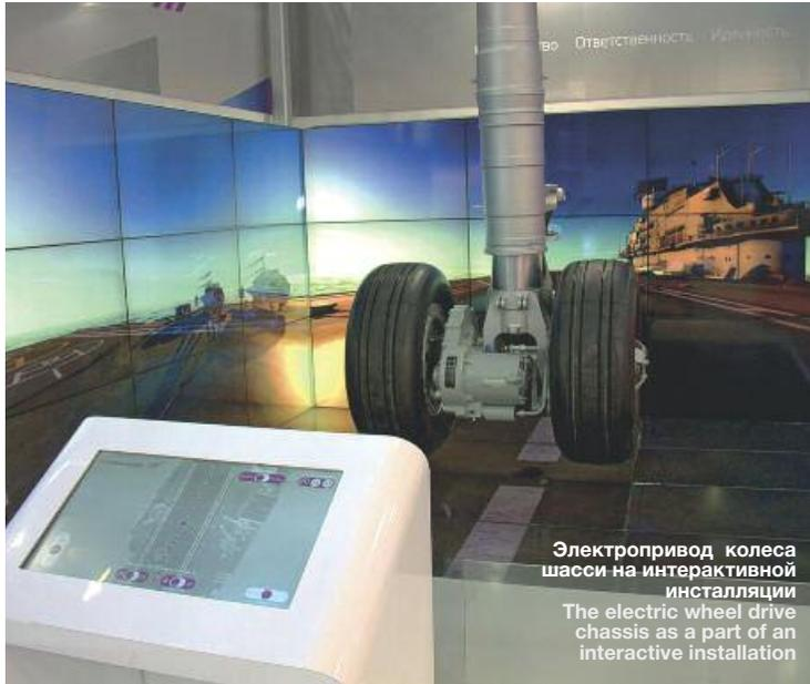
Электропривод колеса шасси на интерактивной установке
