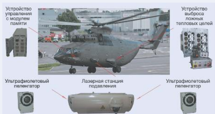
Расположение основных составных частей бортового комплекса обороны «Президент-С26Т2» на вертолете Ми-26Т2
