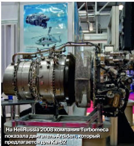
На HeliRussia 2008 компания Turbomeca показала двигатель Ardiden, который предлагается для Ка-62
