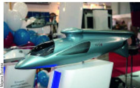
каз от использования подъемного винта. Как объяснил Михеев, на Ка-90 подъемный винт будет использоваться только во время вертикального взлета и посадки, а в горизонтальном полете он будет складываться. За счет такого необычного конструктивного решения Ка-90, по планам разработчиков, сможет летать со скоростью 700 км/ч.
