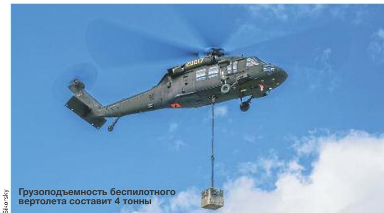
Грузоподъемность беспилотного вертолета составит 4 тонны
