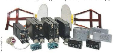
ориентироваться в условиях радиоэлектронных помех, а также при отсутствии спутниковой связи и сигналов традиционных навигационных систем ГЛО-HACC/GPS. Благодаря автоматическому определению типа поверхности — вода, земля, лес — удается исключить в ряде случаев человеческий фактор и вероятность некоторых ошибок пи-
