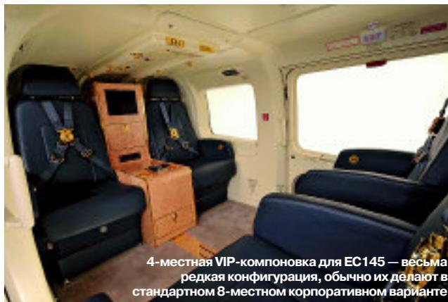
4-местная VIP-компоновка для ЕС145 — весьма редкая конфигурация, обычно их делают в стандартном 8-местном корпоративном варианте
