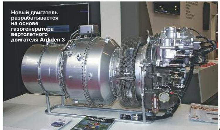
Новый двигатель разрабатывается на основе газогенератора вертолетного двигателя Ardiden 3
