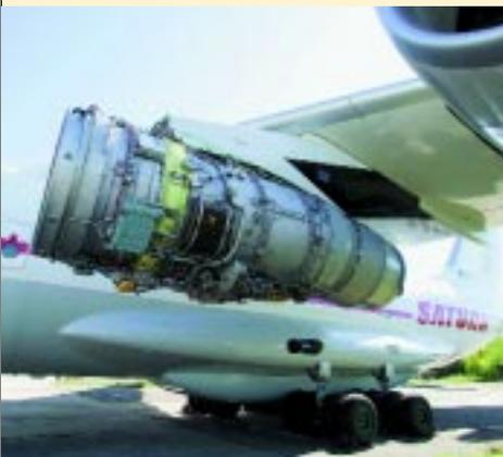
«Сатурн» на собственные средства уже довел двигатель до этапа летных испытаний, приобрел Ил-76 и оборудовал летающую лабораторию
