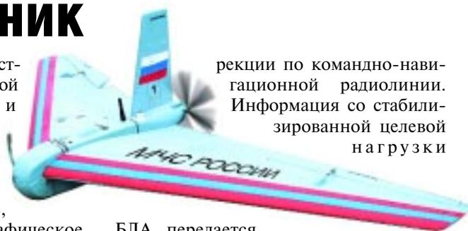
БЛА передается на наземную станцию управления и переносной видеотерминал. Система управления обеспечивает автоматический возврат БЛА в заданную точку после выполнения задания.
