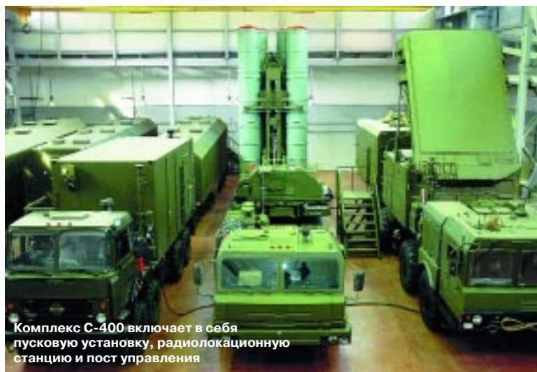
Комплекс С-400 включает в себя пусковую установку, радиолокационную станцию и пост управления
