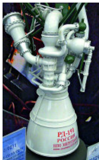
Кислородно-керосиновый двигатель РД-191 будет выводить на орбиту ракеты семейства «Ангара»
